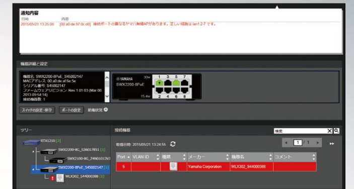
接続ポート間違い
