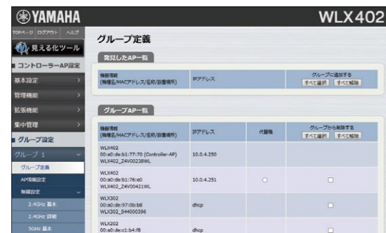
無線LANコントローラーの設定画面
