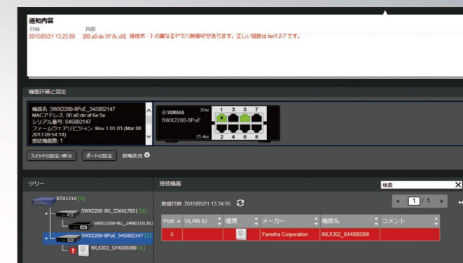
接続ポート間違い
