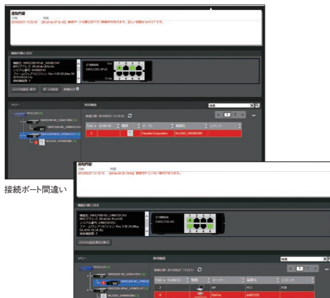
接続ポート間違い
