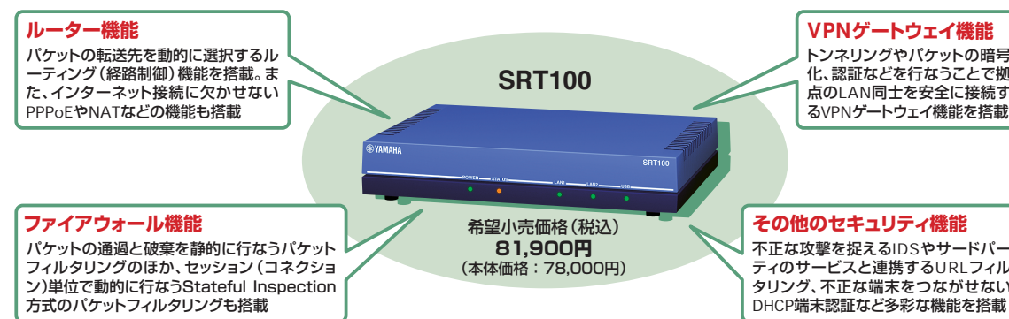
図3 ルーター、VPNゲートウェイ、ファイアウォールなど複数の機能を搭載した「SRT100」
