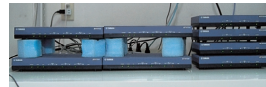
やまや本社サーバーラームに設置している「RTX1000」とカスケード接続された「RTV700」
